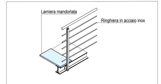
Particolare assonometrico ringhiera in acciaio inox scala 1:25
