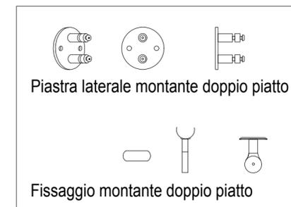
Particolare accessori assemblaggio ringhiera scala 1:25
