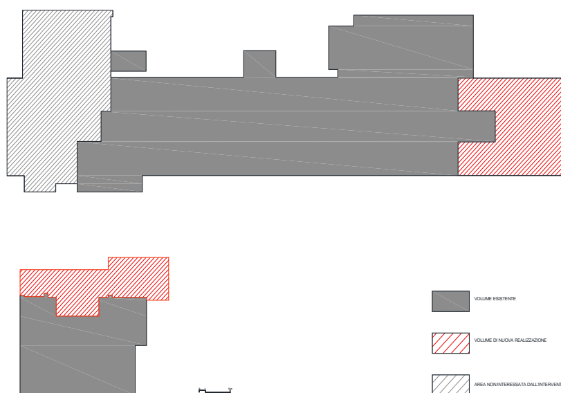
Fig. 7: Schema planimetrico con indicazione dei volumi di nuova realizzazione
